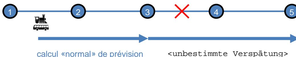
Le train se trouve entre les points d'arrêt 1 et 2 et peut encore continuer jusqu'au point d'arrêt 3.
